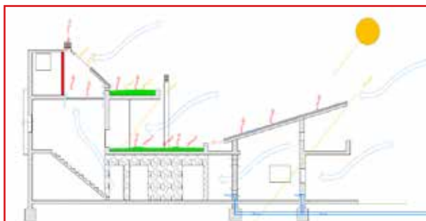
Corte que permite identificar el comportamiento de la edificación según diferentes estrategias (verano en este caso)
